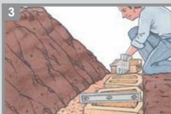
3 Posizionare i blocchi sulla base livellata. Verificare che i blocchi siano posizionati con le punte laterali adiacenti tra loro. Allineare i bordi dei blocchi nella la parte posteriore utilizzando una corda. Dal secondo livello in poi, appoggiare il blocco fino a quando il labbro della parte inferiore non è a contatto con il blocco sottostante.
