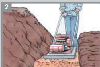
2 Versare 15 cm di inerte drenante all'interno della trincea di fondazione per livellare il terreno e compattare.
