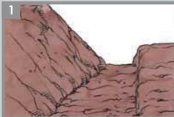
1 Tracciare una linea sul terreno dove verrà costruito il muro, scavare una piccola trincea di 60 cm di larghezza e 30 cm di profondità lungo la linea.
